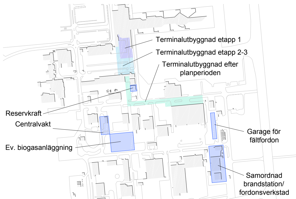
Markreservat i driftområdet samt planerad terminalexpansion
